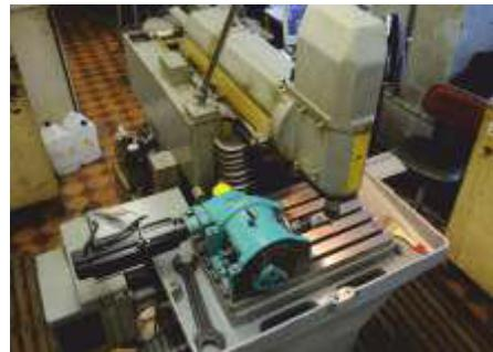
заказу – модернизации фрезерного станка FK-100, который находился на том же заводе. Пару слов об этом станке. Это станок чешской фирмы TOS, Frezer Korir – 100. Горизонтально-фрезерный копировальный станок. Длина рабочих перемещений 2000x800x600 мм. Мощность шпинделя 15 кВт. Копировальный щуп станка давно не работает, а сам станок использовали для обдирки габаритных заготовок.
